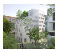
Plutôt qu'un immeuble linéaire, les architectes ont dessiné deux plots compacts séparés par une faille de 8 à 12 mètres. Le choix de la compacité permet de diminuer les hauteurs et préserver ainsi l'ensoleillement des immeubles existants, tout en offrant de bonnes conditions thermiques tandis que la faille laisse pénétrer la lumière en cœur d'ilot. Ce parti pris autorise également une très bonne organisation des logements dont la majorité bénéficie d'une double ou triple orientation.
